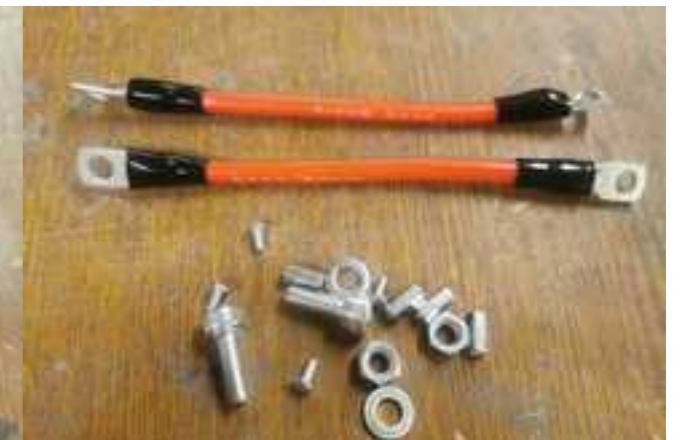
Verbindungskabel Kondensatorbank - Punktschweißgerät
